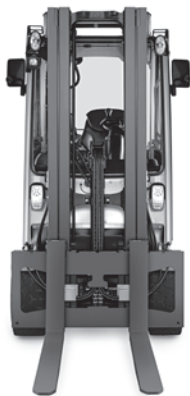
Höchste Sicherheit durch ein schlankes Hubgerüst für hervorragende Sicht auf die Gabeln
