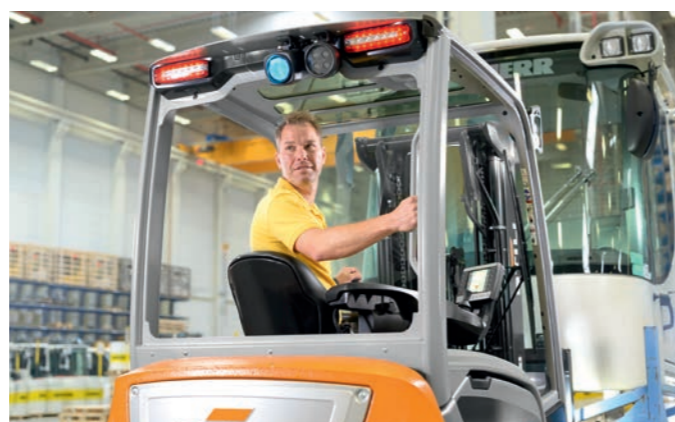
Schwenksitz Haltegriff mit optionaler Hupenbetätigung für ergonomisches Rückwärtsfahren
