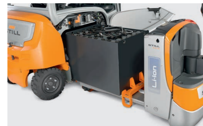
Batteriewechsel mit Elektrohubwagen
