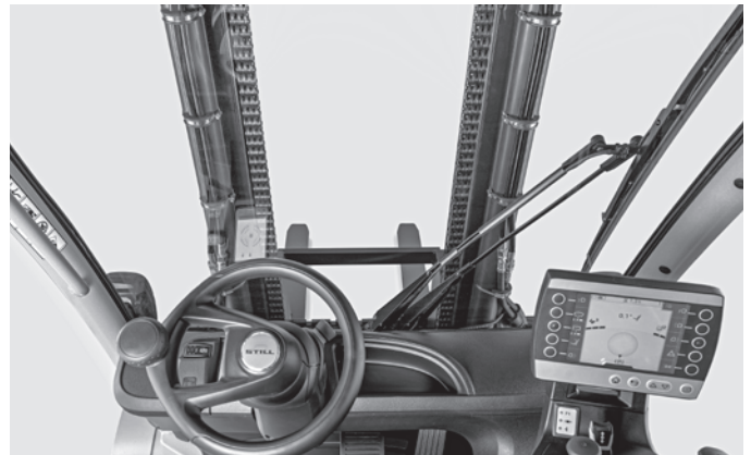
Tele-Hubgerüst für eine hervorragende Sicht nach vorn
