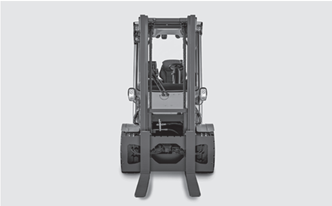
Höchste Sicherheit durch ein schlankes Hubgerüst für hervorragende Sicht auf die Gabeln
