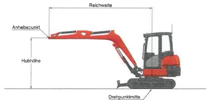
\* Die technischen Daten über den Arbeitsbereich der Maschine wurden mit dem Kubota Original-Tieföffel ermittelt, ohne Schnellwechseleinrichtung.
