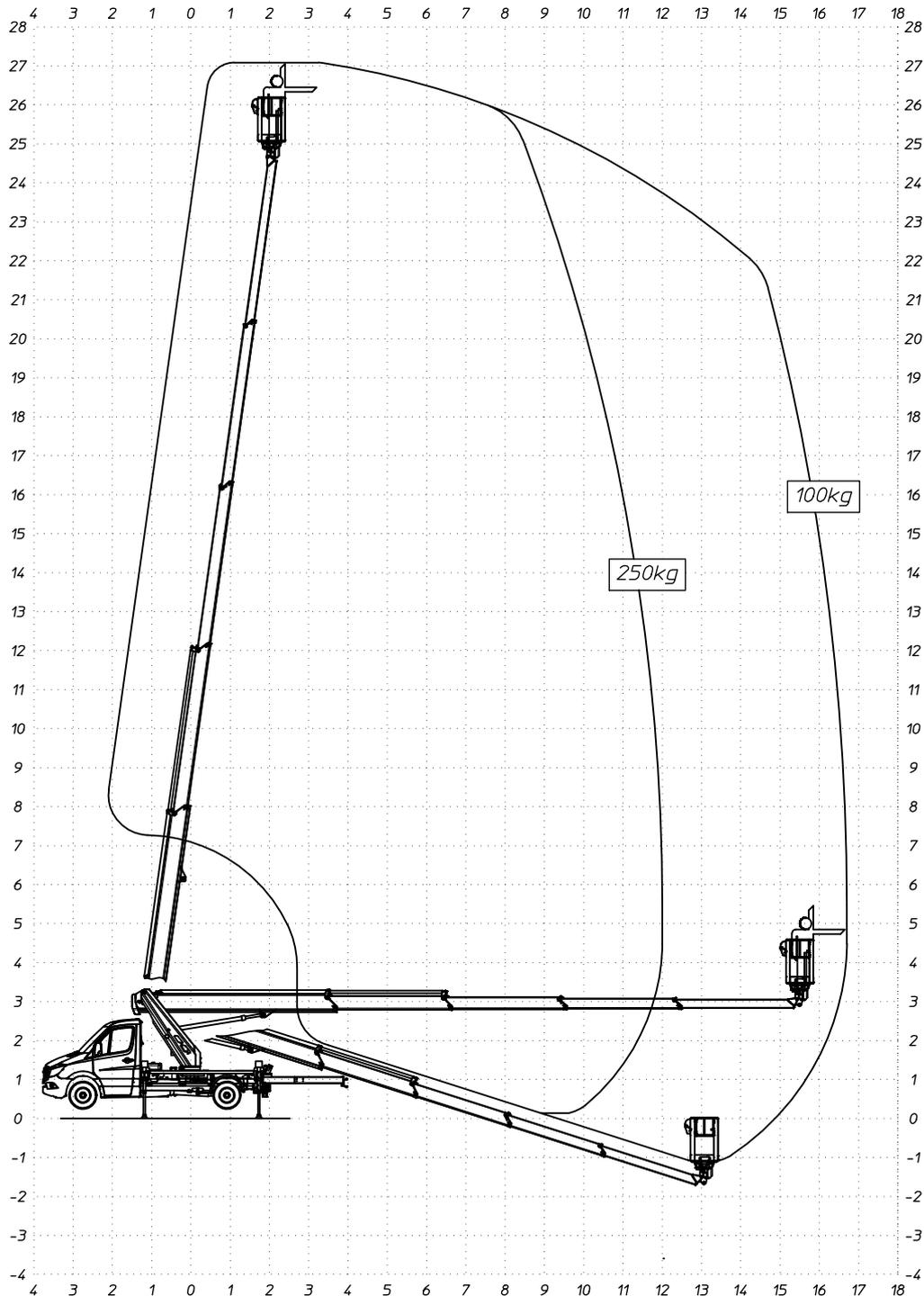
Macchina dotata di sistema di limitazione dello sbraccio a controllo di momento, le linee del grafico rappresentano le condizioni limite, ovvero con il carico massimo (carico nominale) e con il carico minimo (peso di una persona senza attrezzi - 80kg). Per ogni carico compreso tra questi due valori si ottiene una curva che sta tra le due linee tracciate.
