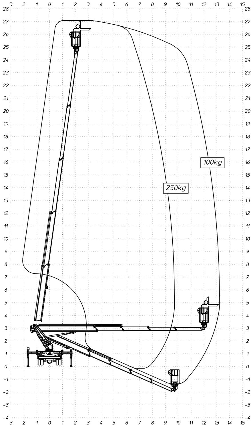
Macchina dotata di sistema di limitazione della sbarrata a controllo di momento, le linee del grafico rappresentano le condizioni limite, ovvero con il carico massimo (carico nominale) e con il carico minimo (peso di una persona senza attrezzi - 80kg). Per ogni carico compreso tra questi due valori si ottiene una curva che sta tra le due linee tracciate.
